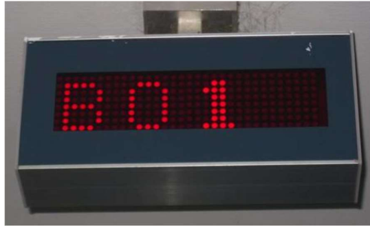
ภาพที่ 4.7.2 หน้าจอแสดงตำแหน่งเตียง (Corridor display)
