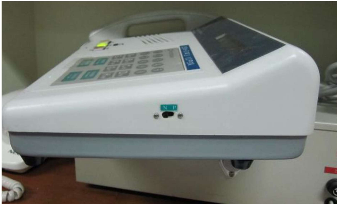
ภาพที่ 4.5.7 สวิตช์เลื่อนโปรแกรม N-P (N=Normally, P= Program)
